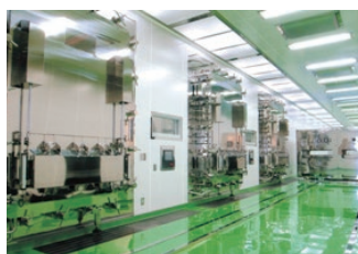
凍結乾燥機および自動搬出入装置
